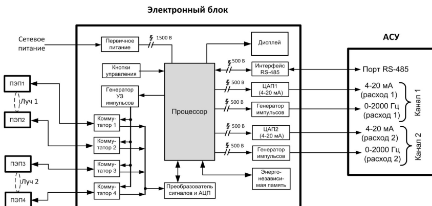
Рисунок 3.1 – Функциональная схема расходомера
