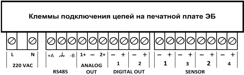
Рисунок Б.8 – Расположение цепей на клеммнике электронного блока для электромонтажа
